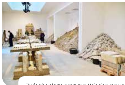
Zwischenlagerung zur Wiederverwendung
